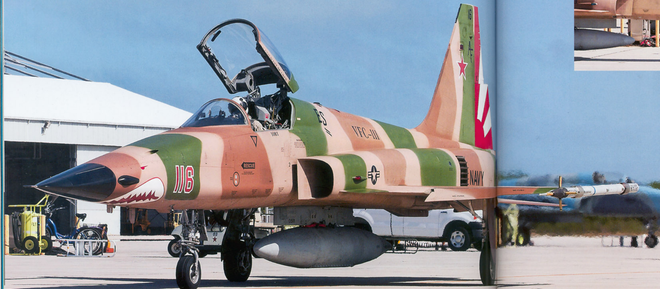
タキサーアウトするVFA-111のF-5N 116番機 (b/n 761532)。機首に緑のある色数字を描くのは、もちろん仮想敵に似せているから。左主翼端に搭載しているのは、空対空戦闘訓練の機動を計測するキュービックP5テレメトリ・ポッド。右主翼端にAIM-9の訓練弾を搭載することもある
