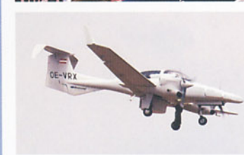
左上/世界で唯一、人工降雨ミッションが可能なアルファジェット245。機首に高性能な気象レーダーを持ち、雲の中で化学薬品を散布して雨を降らせる 左中/エキスポは4~6日がトレード・デー、7日がパブリック・デーだった。写真は4日の開会セレモニー。モロッコ空軍のCL-415による派手な放水デモを見守る来賓の各国軍高官 (Photo:USAFE) 左下/オーストリアのダイヤモンド社DA-42MP (多目的プラットフォーム)。国境警備、監視、洋上哨戒などができ、世界各国で実績のある低コストな機種。今回もっとも各国の関心を買った機種のひとつ 上/写真は8日の基地外周。UH-72アラコタをルイジアナ州フォートボーク陸軍基地から空輸したC-17が、見物人の前を通り過ぎてゆく
