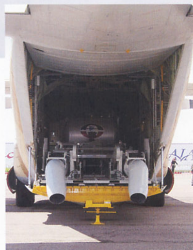
モロッコ空軍C-130Hの空中放水。機内に巨大な放水装置を設置し、開いたランプドアから2本のノズルを出して、そこから水を落とす
