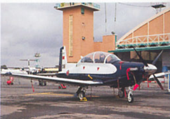
モロッコ空軍がローンチカスタマーとなった、ホーカー・ビーチクラフトT-6CテキサンII練習機。F-16パイロットの養成にも使える先進アビオニクスを備えている
