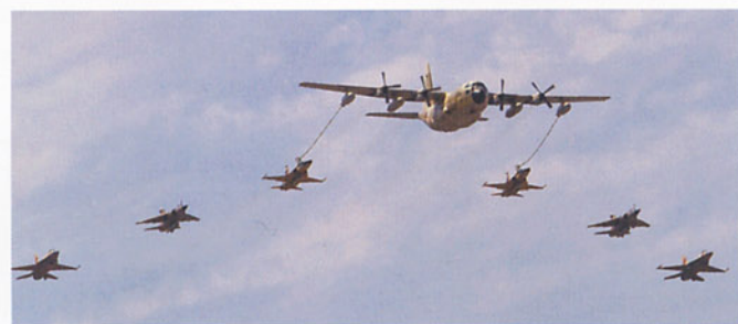
KC-130と戦闘機6機による空中給油デモ。給油を受けているのはF-5×2機、その両脇にミラージュF1が追随し、F-16はエスコートという役回り。ミラージュF1は、現在27機をミラージュ2000-5/9と同等のアビオニクスを持つミラージュMF2000にアップグレード中
