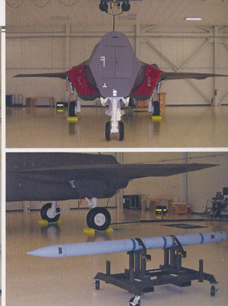
上/正面からみたWLT。右主翼はF-35A/B、左主翼はF-35Cのもの。C型はA/B型に比して翼長が4フィート(約1.22m)長い。胴体の主要部はF-35Aで、左エアインテーク上には内装型機関砲のふくらみがある 下/WLTの脇に置かれたAIM-120空対空ミサイルの訓練弾。F-35は胴体内左右の兵器倉にAIM-120を1発ずつ搭載できる。主翼下には、内側と中央のステーションにパイロンを介して片側最大4発を搭載できる
