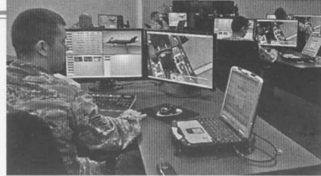
航空機システム整備トレーナー(ASMT)を使用したバーチャル訓練。アカデミック訓練センターでの17日間武装熟練クラスでのワンシオン。ポータブルメンテナンス・エイド(PMA)をASMTに接続して使用すると、実機を使用した訓練と同様の効果が得られる(写真: Eglin AFB)
