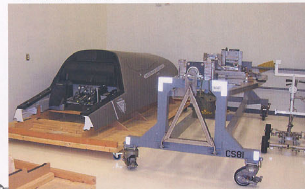
ESMTに装着されるF-35Bコクピット用の胴体パーツ。F-35Bのキャノピーはコクピットのすぐ後ろにリフトファンが位置するため、F-35A/Cに比べて小型のものとなっている
