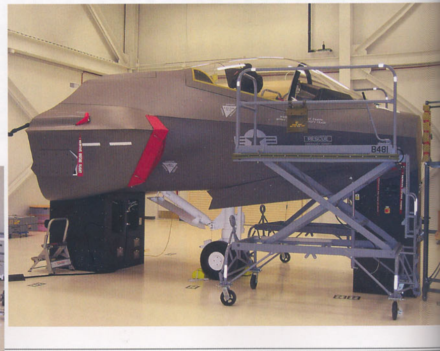
アカデミック訓練センターでの特別整備コースに参加の整備学生とパイロット学生が使用する、射出システム整備トレーナー(ESMT)。機内構造とキャノピーはF-35A/C(写真)、F-35Bどちらにも対応できるように設定可能である
