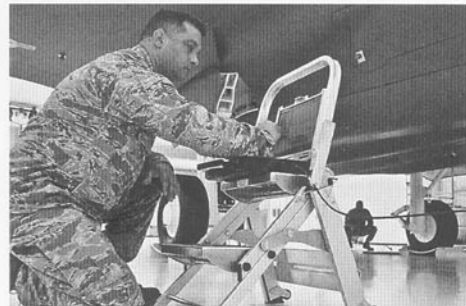
F-35武装搭載トレーナー(WLT)とポータブルメンテナンス・エイド(PMA)を使用した訓練。写真は、PMAから機体へのデータ送信を訓練しているところ(写真: Eglin AFB)
