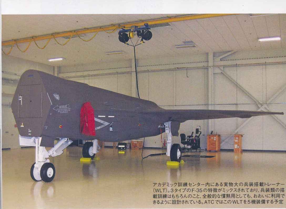
上/正面からみたWLT。右主翼はF-35A/B、左主翼はF-35Cのもの。C型はA/B型に比して翼長が4フィート(約1.22m)長い。胴体の主要部はF-35Aで、左エアインテーク上には内装型機関砲のふくらみがある 下/WLTの脇に置かれたAIM-120空対空ミサイルの訓練弾。F-35は胴体内左右の兵器倉にAIM-120を1発ずつ搭載できる。主翼下には、内側と中央のステーションにパイロンを介して片側最大4発を搭載できる
