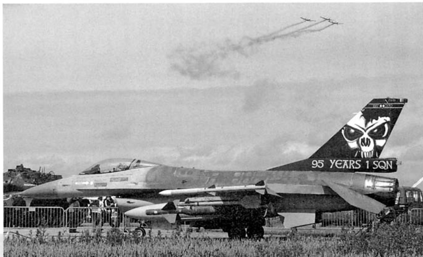
下の写真は、今年6月「フロレンヌ2012」エアショーで展示された、ベルギー空軍95周年塗装F-16AM。翼端から順に、AIM-120空対空ミサイル、AIM-9空対空ミサイル、ハイヴウエイ・レーザー誘導爆弾の訓練弾。上は一般公開前日のスポーツターズ・デーの地上風景(写真:C.JvGent/Phodocu)
