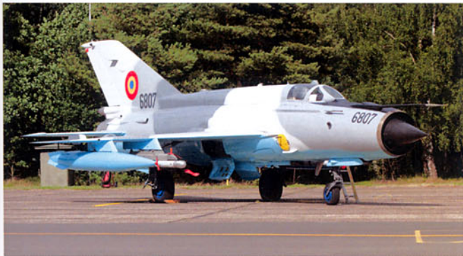
ルーマニア空軍のMiG-21ランサーC。1950年後半に旧ソ連が開発したMiG-21フィッシュベットの近代化改修型の一つで、EL/M-2032マルチモードレーダー、多機能ディスプレイ、DASHヘルメット装着式照準装置機能などを備える。外見は初期のMiG-21とほとんど同じだが、中身は全く別の機体と言ってよいほど能力が向上している（写真：Phodocu）
