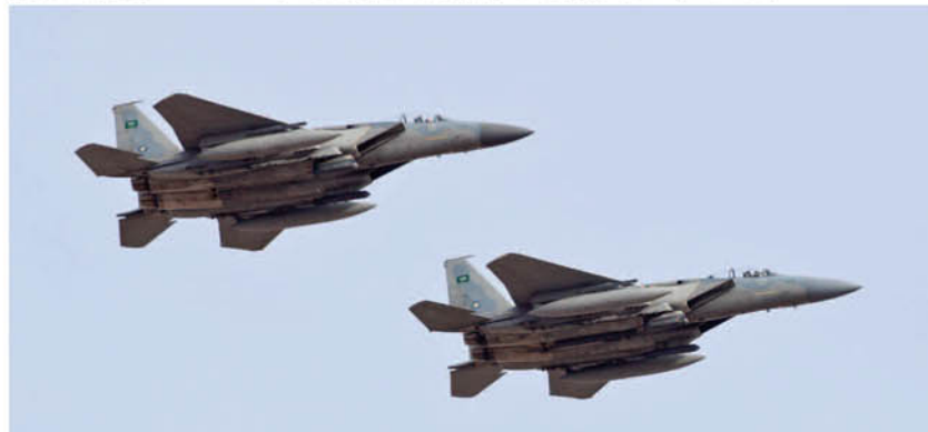
アラブ首長国連邦空軍のF-16F。演習には多くのF-16が参加したが、F-16EおよびF-16Fは、コンフォーマル燃料タンクを背負ったマッシュアップな姿でひととき目立っていた(写真: Johnny Walkman) サウジアラビア空軍のF-15S編隊。両機とも胴体下面の前方右側のパイロンにAN/AAQ-19目標指示ポッド、左側のパイロンにAN/AAQ-20航法ポッドを懸吊している(写真: Johnny Walkman)
