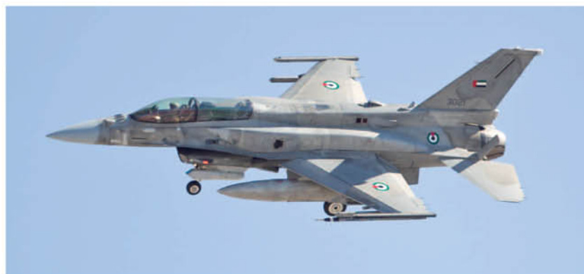
アラブ首長国連邦空軍のF-16F。演習には多くのF-16が参加したが、F-16EおよびF-16Fは、コンフォーマル燃料タンクを背負ったマッシュアップな姿でひととき目立っていた(写真: Johnny Walkman) サウジアラビア空軍のF-15S編隊。両機とも胴体下面の前方右側のパイロンにAN/AAQ-19目標指示ポッド、左側のパイロンにAN/AAQ-20航法ポッドを懸吊している(写真: Johnny Walkman)
