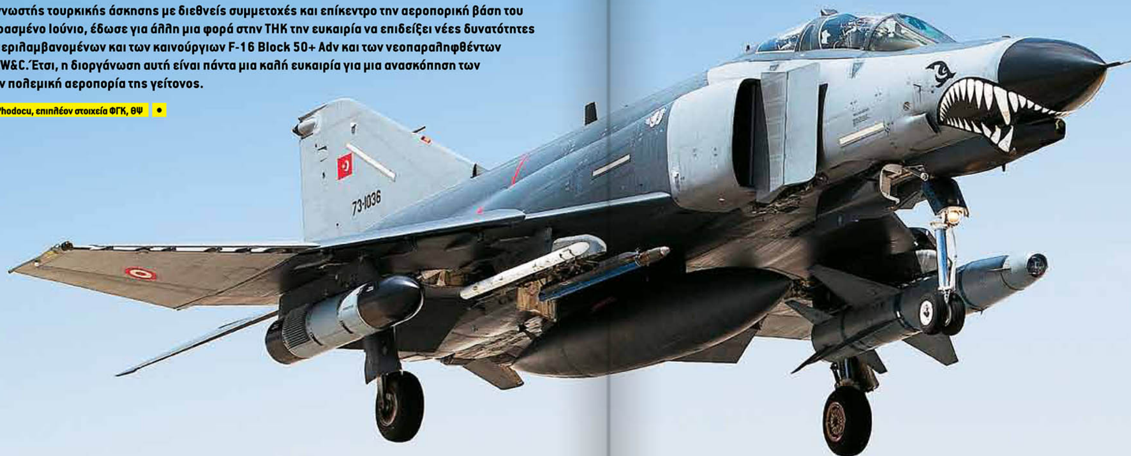
F-4E-2020 της 111 Filo, το οποίο φέρει βλήμα Popeye-1 (AGM-142A) με το ατρακτίδιο ραδιοζεύξης για την καθοδήγηση.
