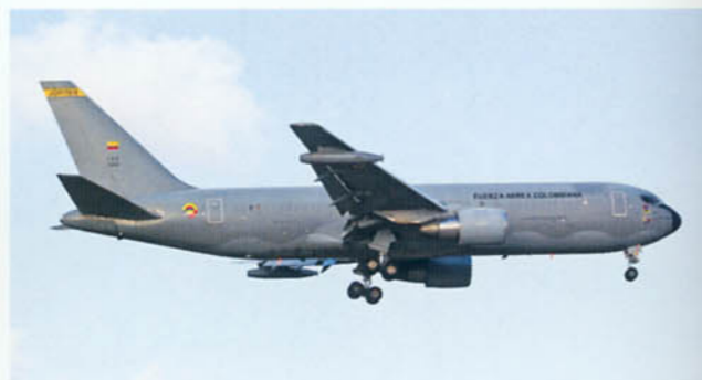
コロンビア空軍のKC-767ジュビター空中給油/輸送機。同じ767をベースにした航空自衛隊やイタリア空軍のKC-767と異なり、給油用のブームは装備していない。2011年には福島第1原発事故から避難する在日コロンビア人を支援するため、日本にも飛来している(写真:Phodocu)
