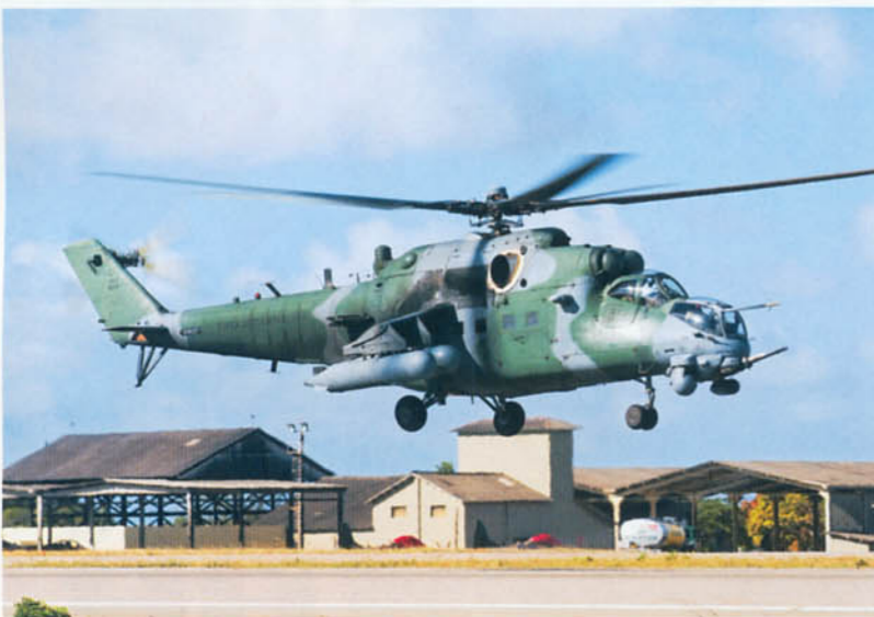
ブラジル空軍のMi-35M攻撃ヘリコプター。Mi-35はMi-24Vの輸出型で、強化型エンジンの採用や夜間作戦能力の強化、コクピットの近代化などの改修が行われている。南米ではブラジルのほかベネズエラとペルーにも採用されている(写真:Daniele Faccioli)
