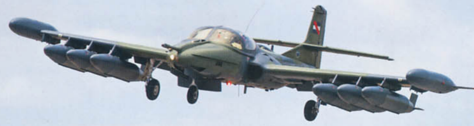
ウルグアイ空軍のA-37B。A-37Bは両主翼下に合計8ヶ所のハードポイントを備えており、写真の機体は計6本のドロップタンクを懸吊している(写真:Phodocu)
